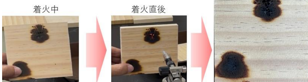
図3-40 アルミナ添加CNFシートの難燃性
