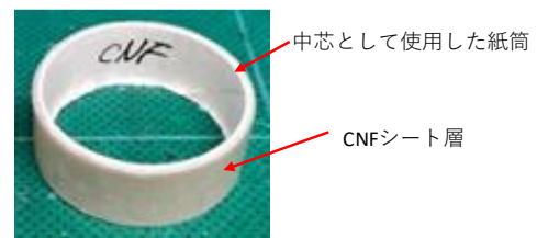
図23 紙筒を中芯に用いたCNF紙管
